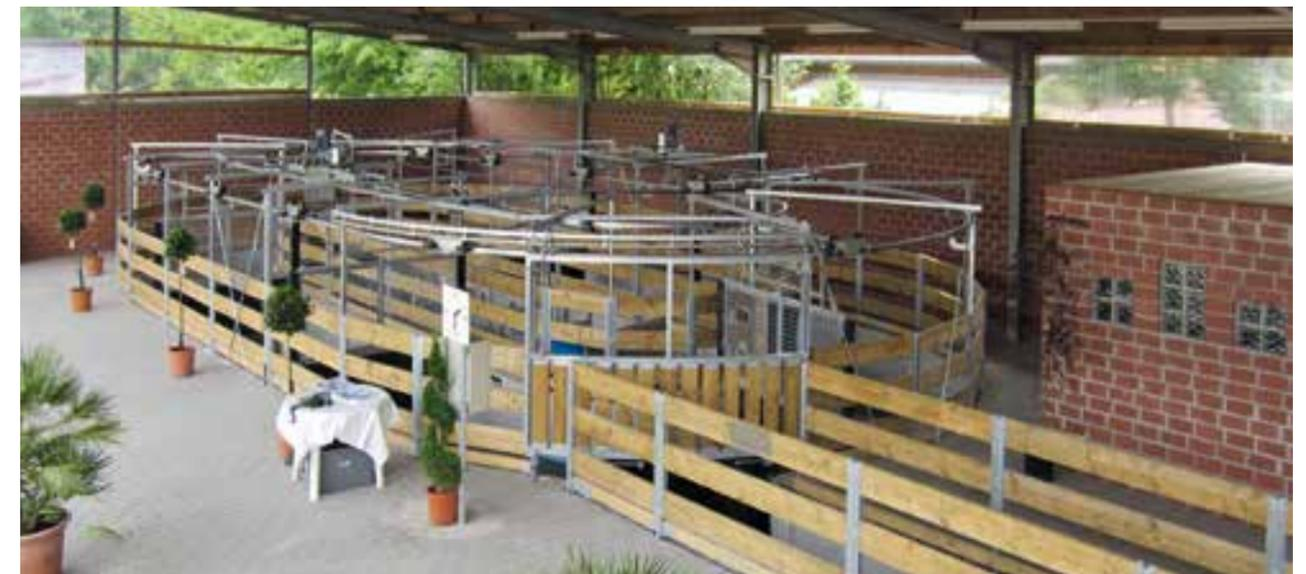
Kombination mit Gleitschienen-Führanlage
